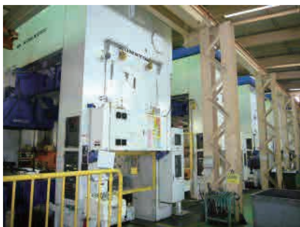
全自动TDN冲压流水线 600t，400t×3台
